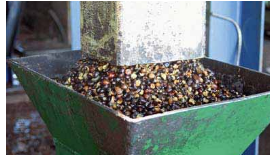
Nach dem Erhitzen kommen die Früchte in die Presse, um Öl zu gewinnen (oben). Im Hafen von Santa Marta lagert das Bio-Öl in eigenen Tanks – damit es nicht mit konventionellem Öl in Berührung kommt.
