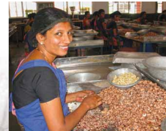
Nach dem Trocknen im Ofen wird die rote Haut von den Cashews entfernt
